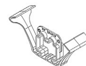
U. Pinza del cable de la viga de electricidad (2)
