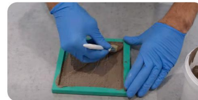
Ketvirtas žingsnis Sutepkite 1–2 mm atsuktą sluoksnį į formą.
