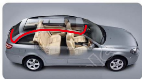
Método de cableado B
