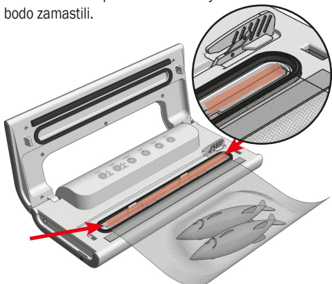
Slika 4: Pri vakuumiranju naj bo rob vrečke v sredini vakuumskega kanala.
