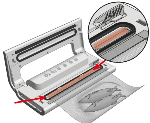
Abbildung 4: Der Beutelrand soll bis zum Positionsmarker in der Mitte der Vakuum-Kammer positioniert werden.
