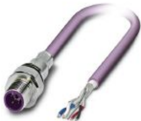
Bussystem-Einbaustecker, DeviceNet/CANopen, 5-polig, M12, geschirmt, A-kodiert, Vorderwand-/Schraubmontage mit M16-Gewinde, positionierbar, mit 1 m Buskabel, 2x 0,2 mm 2 , 2x 0,32 mm 2
