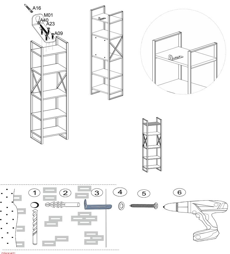
DİKKAT! Dübel montajı öncesinde duvar tipini kontrol ediniz. Dübel çapıyla eşit çapta matkap ile duvar delinir. (08mm) Üniversal plastik dübel gene amaçlı kullanımı sağlar. 2 aşamalı montaj gerektirir. Montaj yapılacak duvar tipine göre dübel değişiklik gösterebilir.
