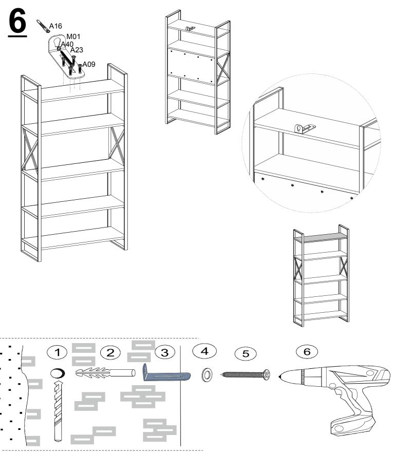
DİKKAT! Dübel montajı öncesinde duvar tipini kontrol ediniz. Dübel çapıyla eşit çapta matkap ile duvar delinir. (08mm) Üniversal plastik dübel gene amaçlı kullanımı sağlar. 2 aşamalı montaj gerektirir. Montaj yapılacak duvar tipine göre dübel değişiklik gösterebilir.
