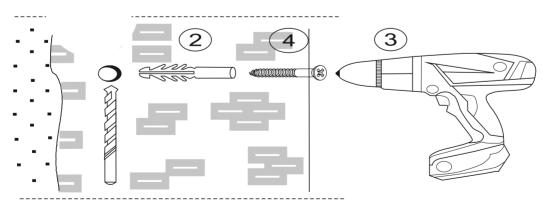
DİKKAT! Dübel montajı öncesinde duvar tipini kontrol ediniz. Dübel çapıyla eşit çapta matkap ile duvar delinir. (08mm) Üniversal plastik dübel genelamaçlı kullanımı sağlar. 2 aşamalı montaj gerektirir. Montaj yapılacak duvar tipine göre dübel değişiklik gösterebilir.
