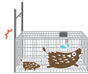
トリガーが作動し扉が閉まる。
