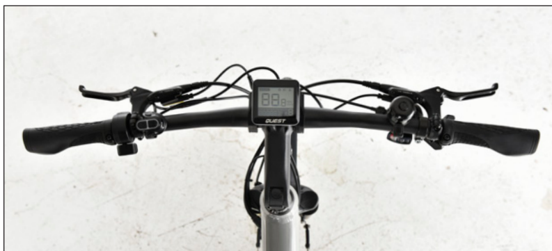
L'unité de commande et l'accélérateur sont situés sur le guidon
