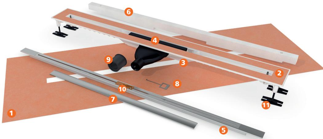
**DE VERPAKKING BEVAT** / 1 Losse flens in Kerlox 2 Vaste flens in Kerlox, voorgelijmd op de Twiggi 3 Twiggi body in High Heat ABS 4 Gepatenteerde sifon met 'Magic Flow' afvoersysteem Ø 40mm 5 Traploos regelbaar RVS rooster 6 Polystyreen tegelblok voor bescherming van de Twiggi tijdens de montage 7 RVS verlengstuk 8 Multisleutel, hulpstuk voor aanpassen roosterhoogte en uitnemen van rooster 9 Afvoerverloopstuk 40-50 mm 10 Afstandhouder 11 regelbare voetjes (54 - 135 mm)
