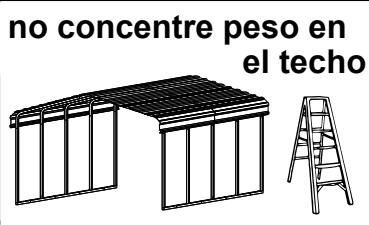
NUNCA concentre su peso en el techo de la estructura. Cuando utilice una escalera de mano, asegúrese de que esté completamente abierta y en terreno nivelado antes de subirse.
