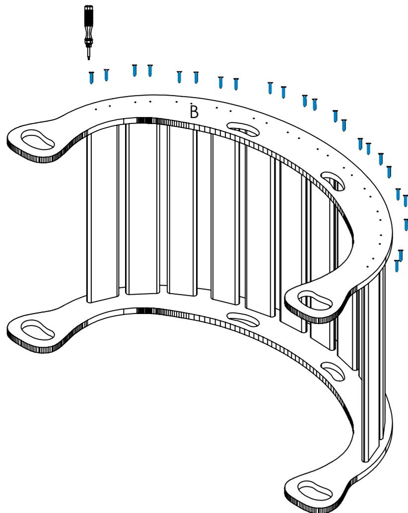
Luego de poner todas las tablas de un lado, das vuelta el arco y realizas el mismo procedimiento del otro lado, (colocar el otro costado, pieza B) que va en la parte superior y atornilla cada tabla con dos tornillos cada una, así como se muestra en la imagen de referencia.
