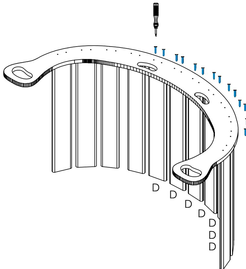
Posteriormente coloca las 7 tablas restantes (pieza D) de la misma manera que los pasos anteriores, atornilla dos tornillos por tabla, como se muestra la imagen de referencia.
