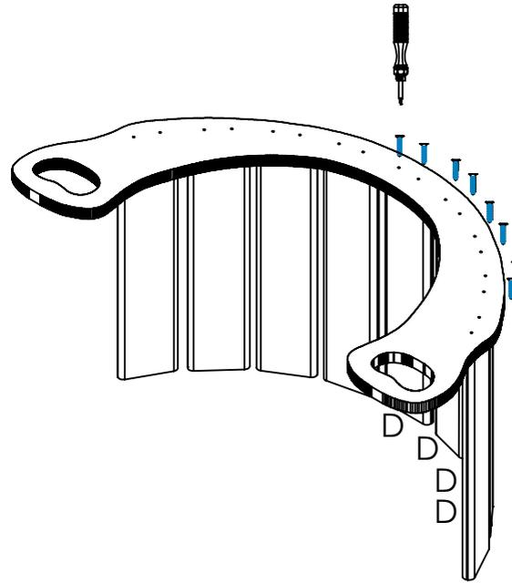
Posteriormente coloca las 4 tablas restantes (pieza D) de la misma manera que los pasos anteriores, atornilla dos tornillos por tabla, como se muestra la imagen de referencia.
