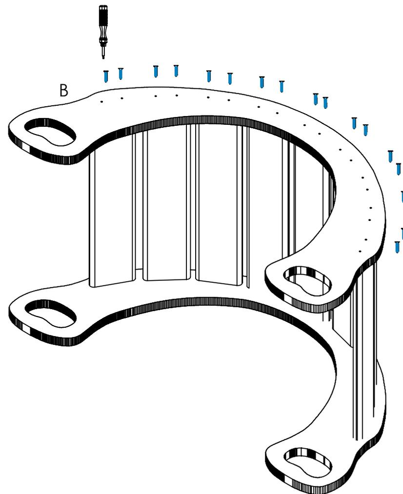
Luego de poner todas las tablas de un lado, das vuelta el arco y realizas el mismo procedimiento del otro lado, (colocar el otro costado, pieza B) que va en la parte superior y atornilla cada tabla con dos tornillos cada una, así como se muestra en la imagen de referencia.
