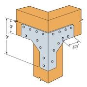
RTC44 Installation (mitered corner)
