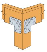
Typical LCE4 Corner Installation (mitered corner)
