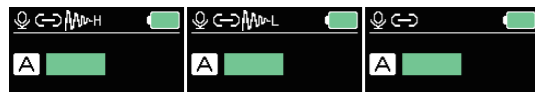
ハイレベルノイズキャンセリング ローレベルノイズキャンセリング ノイズキャンセリング機能オフ
