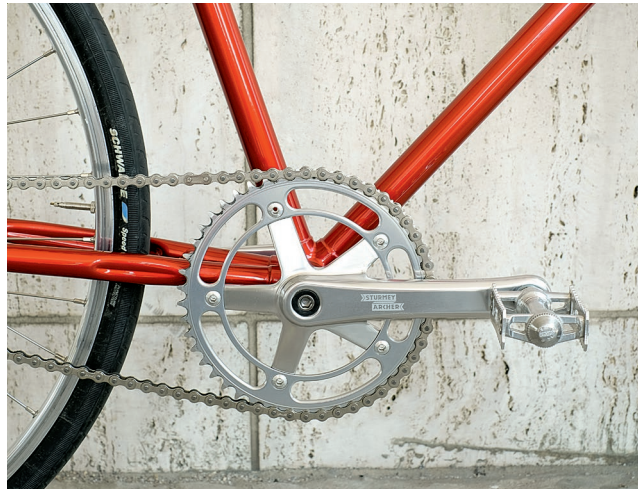
Nicht alle Parts sind italienisch. Wie öfter an Retro-Rädern, findet man am Bella Ciao ein Sturmey-Archer-Kettenblatt mit 48 Zähnen.
