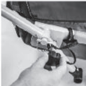
Trailer Mounting Position Position de montage de la remorque
