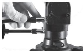
Para facilitar el ajuste exacto de los ejes de declinación y ascensión recta, los ejes flexibles se han colocado en los soportes de ambos ejes, en los lugares diseñados para este propósito. El eje flexible largo está colocado paralelo al tubo del telescopio. Está sujeto con un tornillo abrazadera en la hendidura del eje. El eje corto flexible está colocado lateralmente. Está sujeto con un tornillo abrazadera en la hendidura del eje. El telescopio ya está listo para usar.
