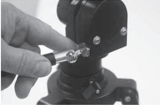
El eje flexible largo está montado en paralelo con el tubo del telescopio. Se fija gracias a un tornillo de abrazadera en el hueco correspondiente del eje.
