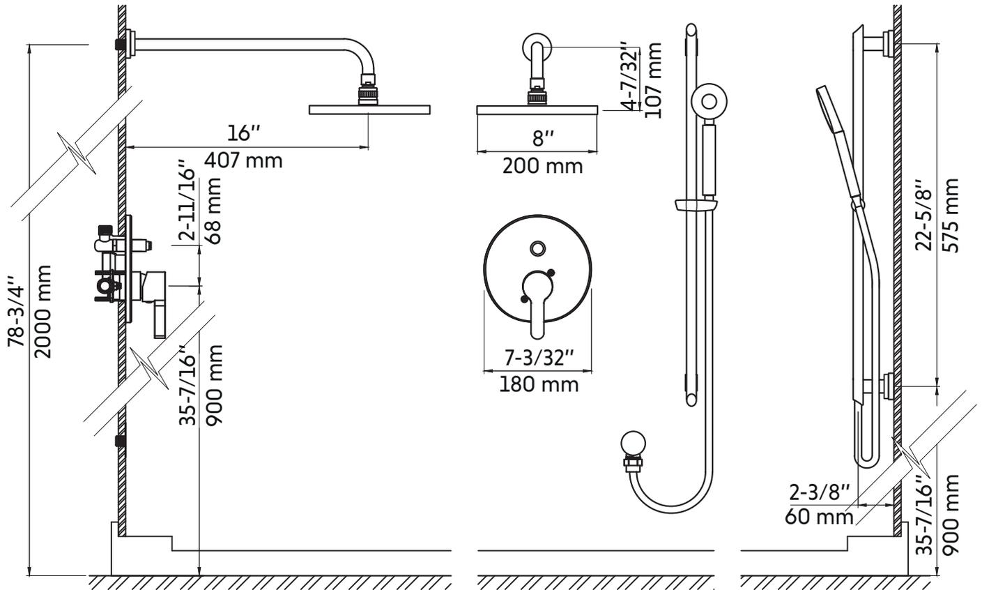
\* Ces dimensions de fixations sont en pouce ou en millimètres et peuvent varier de  $\pm 1/4''$  (6 mm). Le dessin n'est pas à l'échelle. Ces dimensions peuvent être changées à la discrétion du fabricant. Aucune responsabilité n'est assumée.
