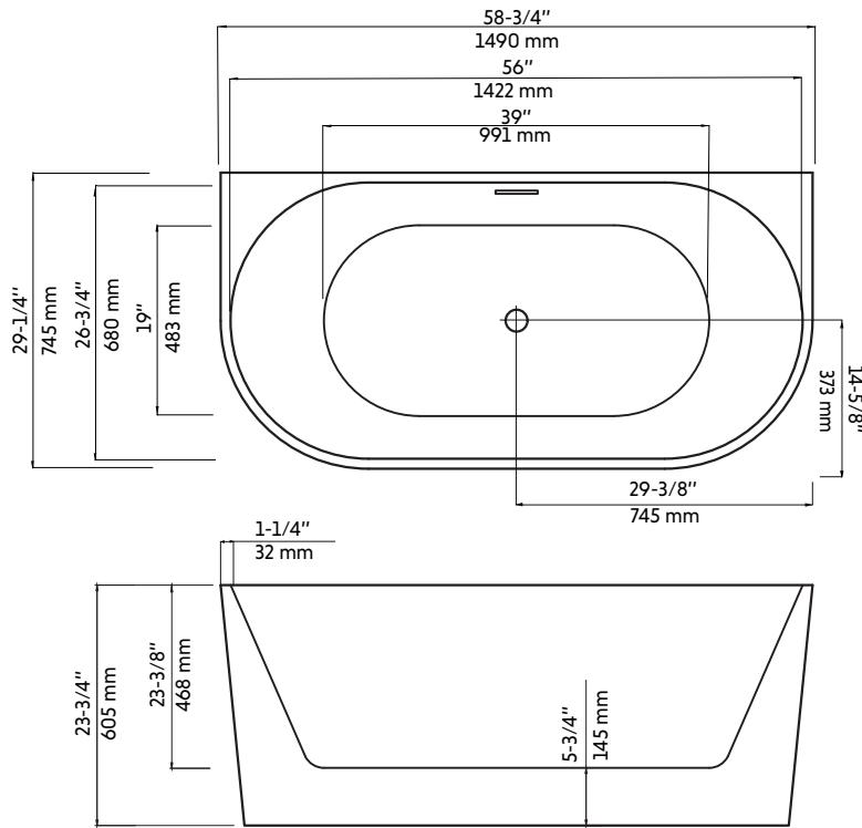
\* Ces dimensions de fixations sont en pouce ou en millimètres et peuvent varier de  $\pm 1/4"$  (6 mm). Le dessin n'est pas à l'échelle. Ces dimensions peuvent être changées à la discrétion du fabricant. Aucune responsabilité n'est assumée.
