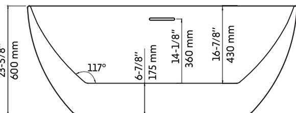
\* Ces dimensions de fixations sont en pouce ou en millimètres et peuvent varier de ± 1/4" (6 mm). Le dessin n'est pas à l'échelle. Ces dimensions peuvent être changées à la discrétion du fabricant. Aucune responsabilité n'est assumée.
