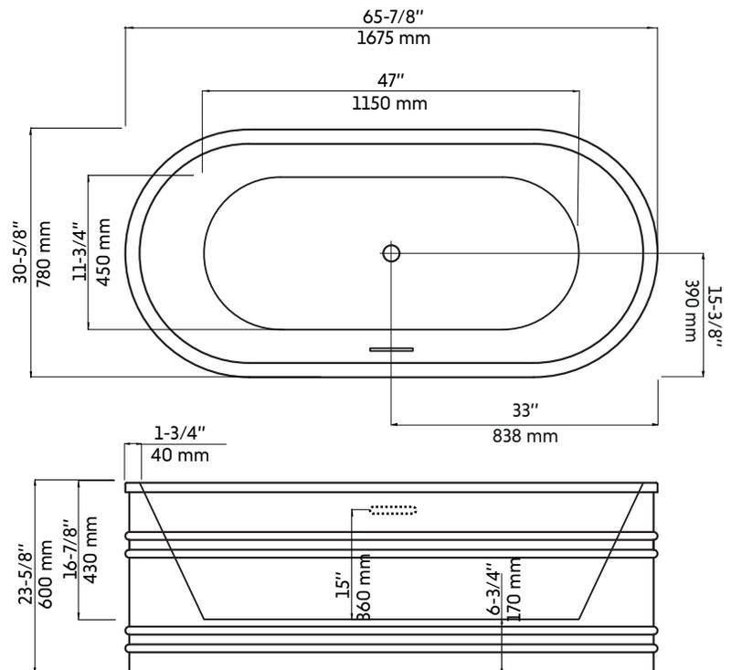
\* Ces dimensions de fixations sont en pouce ou en millimètres et peuvent varier de  $\pm 1/4"$  (6 mm). Le dessin n'est pas à l'échelle. Ces dimensions peuvent être changées à la discrétion du fabricant. Aucune responsabilité n'est assumée.
