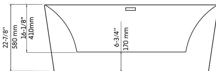
\* Ces dimensions de fixations sont en pouce ou en millimètres et peuvent varier de  $\pm 1/4"$  (6 mm). Le dessin n'est pas à l'échelle. Ces dimensions peuvent être changées à la discréption du fabricant. Aucune responsabilité n'est assumée.
