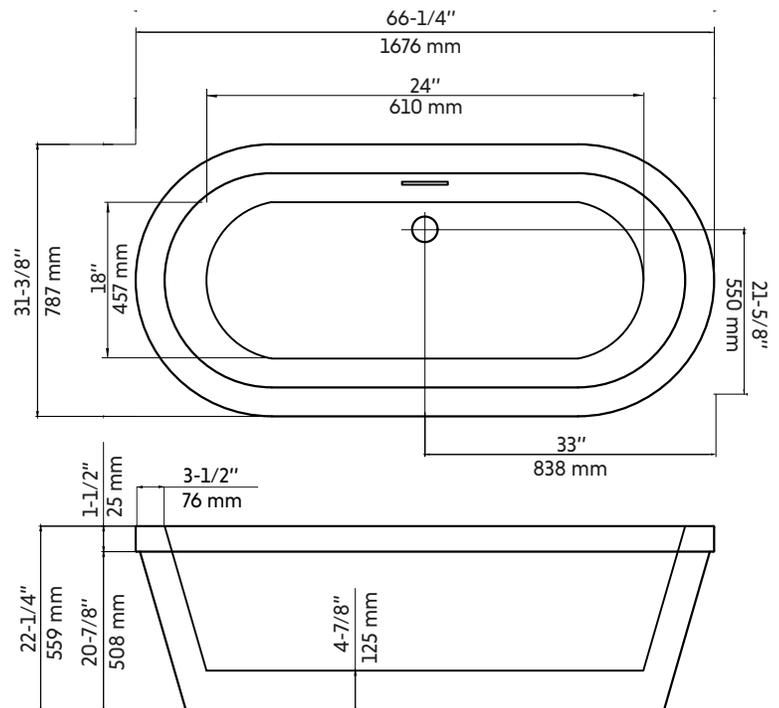
\* Ces dimensions de fixations sont en pouce ou en millimètres et peuvent varier de ± 1/4" (6 mm). Le dessin n'est pas à l'échelle. Ces dimensions peuvent être changées à la discrétion du fabricant. Aucune responsabilité n'est assumée.
