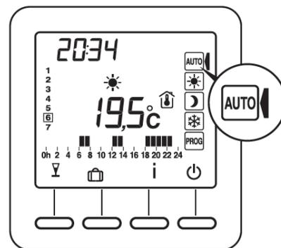
❹ Der Abzählvorgang beginnt. Zurück zum AUTO-Modus und zu den entsprechenden Einstellungen nach Ende des Abzählvorgangs oder durch Drücken auf C.
