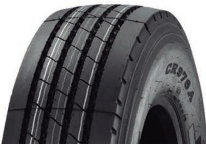
Es una llanta para larga distancia de cinco costillas con cuatro ranuras anchas y recta para una manipulación precisa y tracción excepcional. Las plataformas eyectoras de piedra evitan que las piedras se alojen en las ranuras y perforen en los cinturones. La baja profundidad de la banda de rodadura ayuda a resistir los rebotes y el desgaste irregular para un kilometraje excepcionalmente largo.
