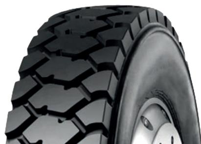
Es una llanta de diseño agresivo con grandes bloques en el centro de la banda. Diseñada para operaciones de minería, roca y cantera. Con banda ancha y compuesto especial que resiste al astillado, fragmentación y rasgado. Su plataforma eyectora de piedra previene que piedras atrapadas afecten el cinturón.
