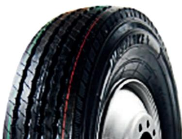
Llanta aplicable para minibuses, furgonetas y vehículos comerciales con paredes laterales fuertes que brindan alta durabilidad y resistencia contra cortes y abrasión. Sus cinturones de triple poliéster crean una fuerza que soporta cargas pesadas con estabilidad superior.
