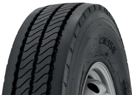
Es una llanta de uso regional para toda posición. Tiene múltiples bordes de adherencia que cortan a través del agua para un mejor agarre al suelo. Con cuatro costillas anchas y continuas que ayudan a resistir el desgaste y abrasión. Con tres canales circunferenciales que proveen tracción en todo clima, carretera húmeda o seca. El diseño de hombro cerrado promueve desgaste uniforme durante toda la vida del neumático.
