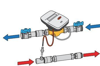
Versone per installazione su tubo di ritorno/ tubo di mandata configurabile in fase di installazione.
