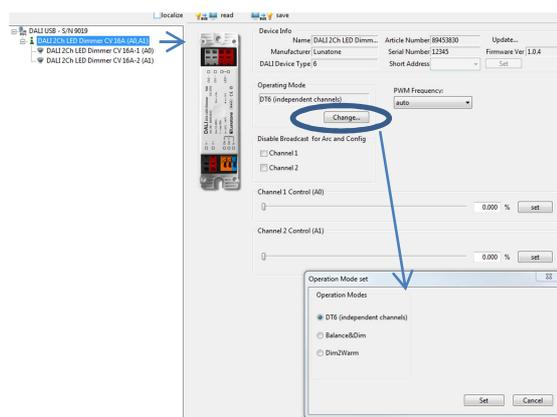
Außerdem kann auf der Übersichtsseite die PWM-Frequenz eingestellt werden und es stehen in jeder Betriebsart Steuerelemente zum Testen der Funktion zur Verfügung (DT6:
