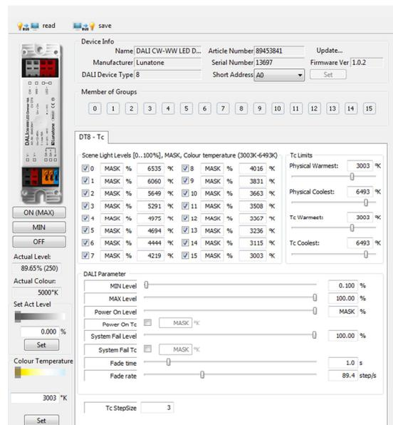
Neben dem Einstellen der DALI-Parameter bietet die Seite auch die Möglichkeit für die Tc-Schrittweite (Tc-Stepsize) anstatt des DT8 Tc-Standardwerts (1) größere Werte zu verwenden und dadurch die Geschwindigkeit der Farbtemperaturverstellung bei Verwendung der Befehle TC STEP COOLER/WARMER zu erhöhen.
