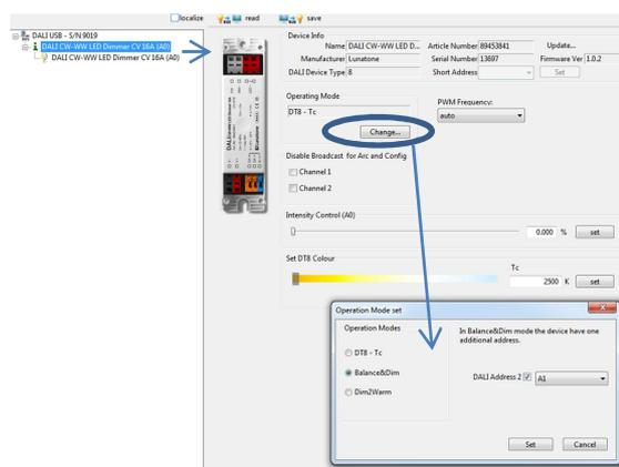
Außerdem kann auf der Übersichtsseite die PWM-Frequenz eingestellt werden und es stehen in jeder Betriebsart Steuerelemente zum Testen der Funktion zur Verfügung (DT8: Schieber für Helligkeit und Farbtemperatur, Balance&Dim: Schieber für Helligkeit und
