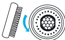
Pour des dépôts calcaires tenaces, retirez le mousseur :
