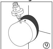
Vertikale Strahlrichtung: Wasserstrahl heben oder senken.
