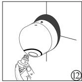
Mit dem Sechskant des Schlüssels lässt sich die ganze Wasser Austritts düse entfernen. Nur nötig zB zur Reinigung nach einem Rohrleitungsbruch. Nicht zu fest anziehen: max. 0,5 Nm.
