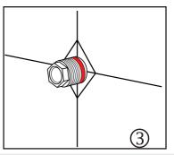
Wandanschluss gut reinigen, evtl. mit Gewindebohrer nach schneiden. Wandbüchse auf Leitungsanschluss schrauben, Sechskant nach aussen, bis 8mm vorstehend, bis 30mm
