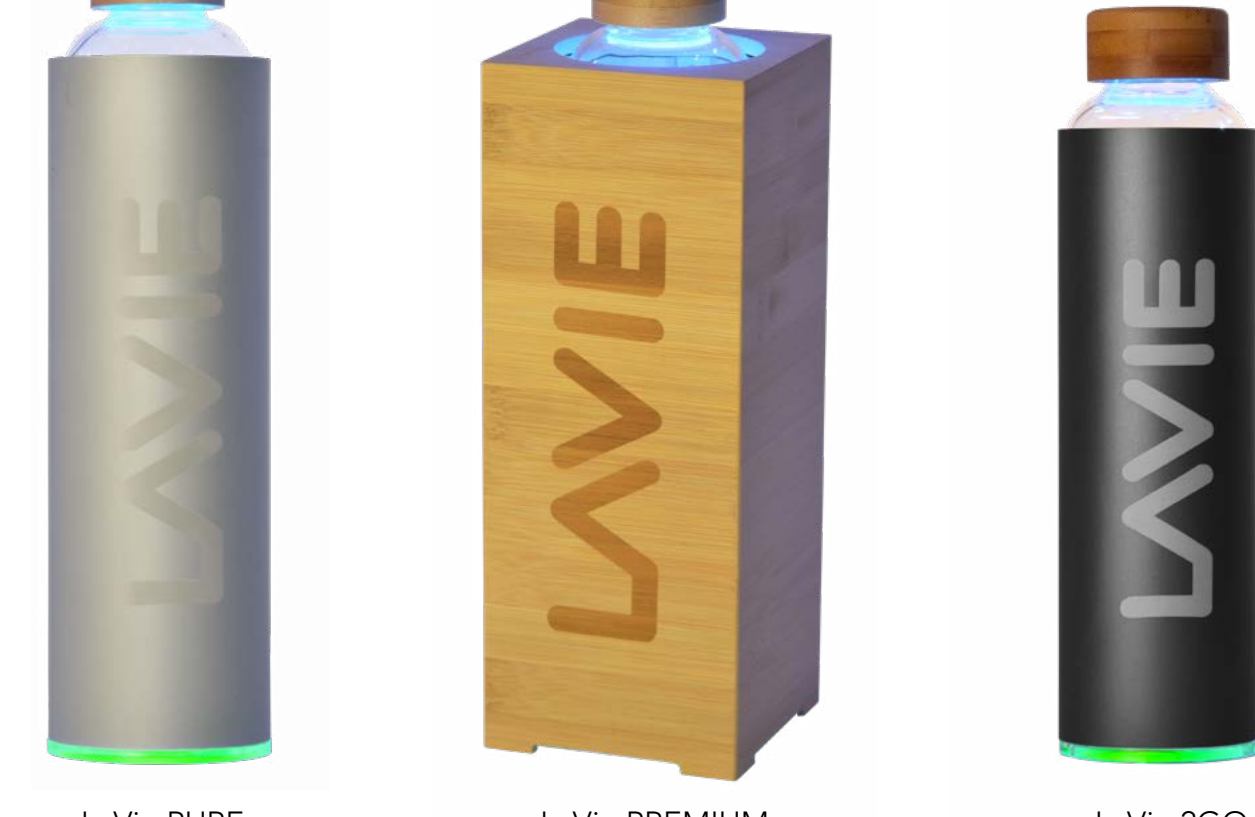
Dispositivo in funzione. La luce blu indica che i LED stanno emettendo radiazioni UV-A e che quindi stanno trattando l'acqua contenuta nella bottiglia LaVie. Alla base della custodia, la luce verde indica una durata del trattamento di 15 minuti.
