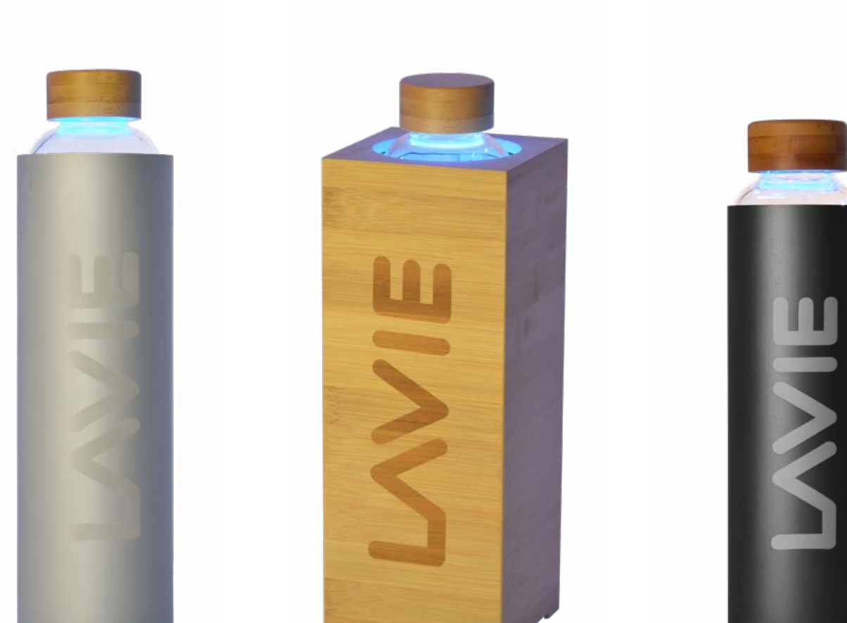
Figura 3: Aparato en funcionamiento. La luz azul indica que los LEDs están emitiendo una radiación UVA en la que están tratando el agua contenida en la botella LaVie. En la base del estuche, el color verde indica que el tiempo de tratamiento será de 15 minutos.
