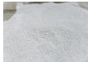
▲ポリエステル樹脂は本来透明だが、強度を高めた結果、白く見えるようになる。
