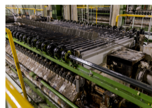
▲固液分離機。ギューターと絞ると、エチレングリコールが抜けたBHETの塊が下に落ちていく。
