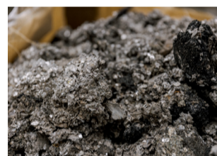
▲ラベルやキャップ等の不純物が混ざったもの。ピカピカ光るのはアルミ箔などの金属。
