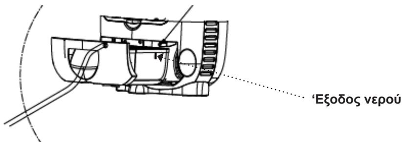
Εάν θέλετε να μη χρησιμοποιείτε πια τη συνεχή ροή, αφαιρέστε το σωληνάκι από τη συσκευή. Βεβαιωθείτε ότι το δοχείο νερού έχει τοποθετηθεί σωστά.
