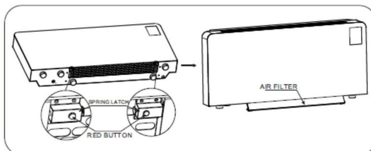
Um den Filter zu entfernen, drücken Sie die beiden einzelnen, roten Knöpfe links und rechts von der Filterabdeckung. Dadurch kann der Filter nach unten herausfallen.
