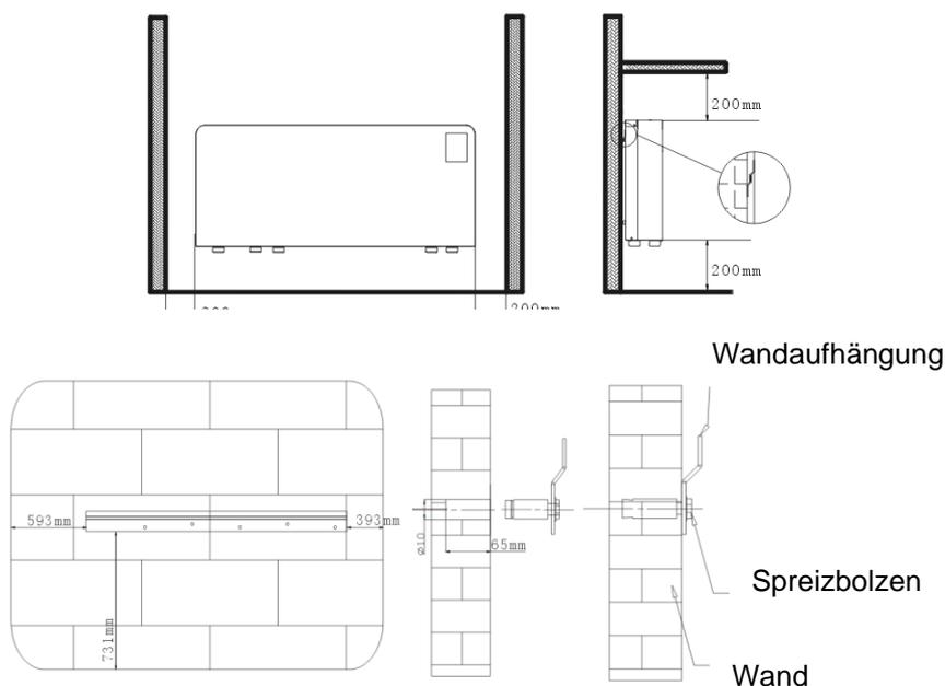
Bohren Sie fünf Löcher für die Wandhalterung, entsprechend den Vorbohrungen, und befestigen Sie diese mit den Spreizbolzen. Bei der Wandmontage müssen Wand und Halterung waagrecht sein, da sonst Wasser aus dem Luftentfeuchter austritt.
