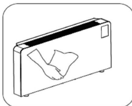
Reinigen Sie die Außenseite mit einem weichen, feuchten Tuch. Verwenden Sie nichts, was die Oberfläche verkratzen könnte, und keine Reinigungsmittel.
