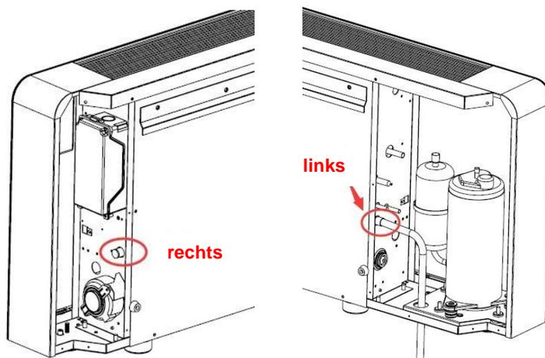
Schließen Sie den Kondensatschlauch (16 mm Durchmesser) an und stellen Sie sicher, dass das Wasser ohne Knicke oder Verstopfungen abwärts fließen kann. Sie haben die Wahl, den Abfluss rechts oder links zu montieren. Der rechte Schlauch ist bereits vormontiert, wenn Sie auf links wechseln möchten, entfernen Sie einfach den Spund auf der linken Seite und tauschen Sie den linken mit dem rechten Schlauch aus.
