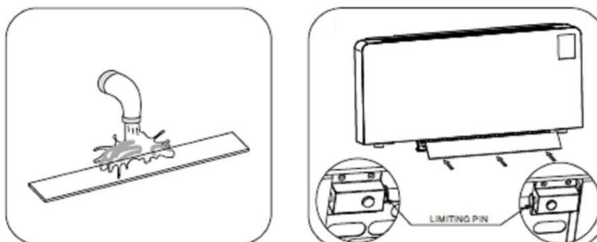
Waschen Sie den Filter in Wasser und lassen Sie ihn vor dem Wiedereinbau vollständig trocknen. Sobald der Filter trocken ist, setzen Sie ihn wieder ein und lassen Sie die Sicherungsfedern rechts und links wieder einrasten.
