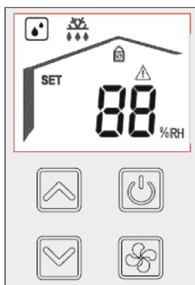
Wenn der Luftentfeuchter eingeschaltet wird, erscheint auf dem Display 88 und dann zehn Sekunden lang die Programmversionsnummer. Damit kann der Sensor für die relative Luftfeuchtigkeit eine Luftprobe entnehmen und eine Messung vornehmen. Die Anzeige wird nach 90 Sekunden ohne Tastenbetätigung abgeblendet.
