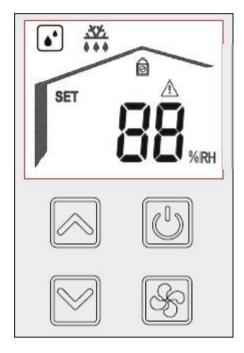
Lorsque le déshumidificateur est allumé, l'écran affiche 88, puis le numéro de version du programme pendant dix secondes. Cela permet au capteur d'humidité relative de prélever de l'air et d'effectuer une mesure. L'écran s'assombrit après 90 secondes sans pression sur aucune touche.
