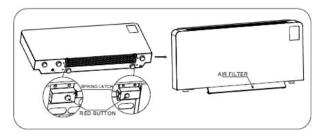
Pour retirer le filtre, appuyez sur les deux boutons rouges à gauche et à droite de la protection du filtre. Cela permettra au filtre de tomber.
