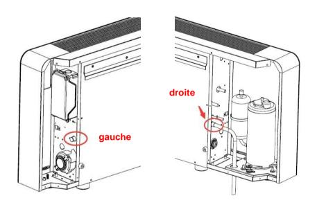
Raccordez le tuyau de condensat (16 mm de diamètre) et assurez-vous que l'eau coule vers le bas sans pliure ni obstruction. Vous avez le choix d'installer le drain à droite ou à gauche. Le tuyau est préinstallé à droite. Si vous souhaitez le placer à gauche, retirez le bouchon à gauche et placez-y le tuyau qui se trouve à droite.
