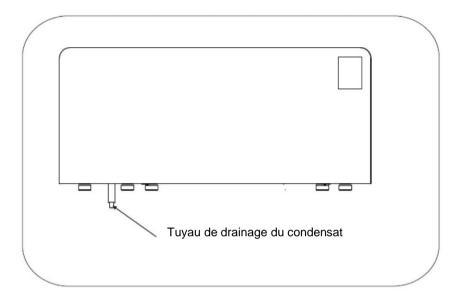
Si vous souhaitez déplacer le drain vers l'autre côté, vous pouvez le faire en retirant les couvercles latéraux – cette opération ne doit être effectuée que par un électricien qualifié et uniquement lorsque l'alimentation électrique de l'appareil a été coupée et isolée.
