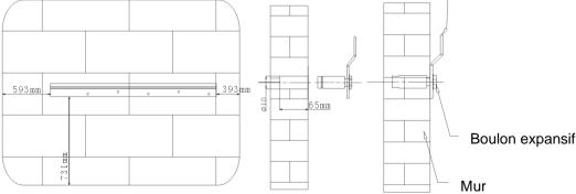
En utilisant ce qui est inclus, percez cinq trous pour le support de montage mural et fixez-le à l'aide des boulons expansifs. Lors du montage mural, le mur et le support doivent être à niveau, sinon l'eau s'écoulera du déshumidificateur.
