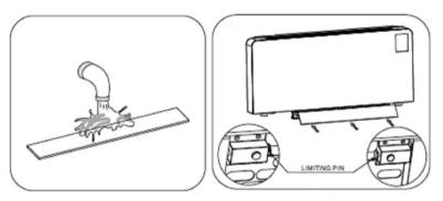
Laver le filtre à l'eau et laisser sécher complètement avant de le remettre en place. Une fois le filtre sec, réinsérez-le et laissez les ressorts de sécurité se clipser à droite et à gauche.
