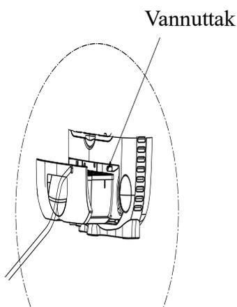
Hvis ikke vannet renner ned slangen så sjekk at det er fall på den, at ikke slangen er ikke bøyd, at overflødig slange har blitt kuttet av og ikke er blokkert. Hvis vannet fremdeles ikke renner kan du lage et 4 mm hull, 20 mm ut fra luftavfukteren på toppen av slangen. Dette vil balansere ut lufttrykket og tillater vannet å strømme. Når du ikke lenger ønsker å bruke det permanente vannavløpet kobles dreneringsslangen fra enheten. Sørg for at vannbeholderen er plassert riktig.
