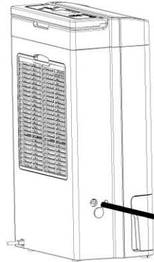
2. Entnehmen Sie den Behälter, drücken Sie den Tropfverschluss nach hinten und schieben Sie den Schlauch auf den Wasserauslass.
