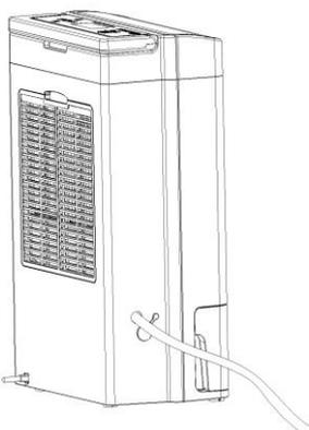
Wenn Sie feststellen, dass das Wasser in den Behälter zurückfließt, obwohl der Schlauch nach unten zeigt, weder abgeknickt noch verstopft ist. Bohren Sie bitte oben in den Schlauch (30 mm von der Abflussöffnung entfernt) ein Loch mit einem Durchmesser von 4 mm um Luft hineinzulassen und die Luftdruckdifferenz auszugleichen, die das Wasser aktuell am Abfließen hindert.
