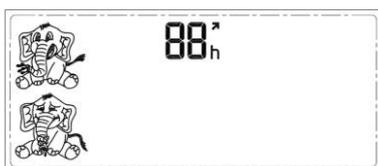
Wenn der Luftentfeuchter ausgeschaltet wird und sich im Standby-Modus befindet, können Sie den Rechts-Pfeil drücken, um zur Stunden-Einstellung in der oberen Reihe zu wechseln.
