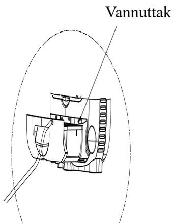
Hvis ikke vannet renner ned slangen så sjekk at det er fall på den, at ikke slangen er ikke bøyd, at overflødig slange har blitt kuttet av og ikke er blokkert. Hvis vannet fremdeles ikke renner kan du lage et 4 mm hull, 20 mm ut fra luftavfukteren på toppen av slangen. Dette vil balansere ut luftrykket og tillater vannet å strømme. Når du ikke lenger ønsker å bruke den permanente vannavløpet kobles dreneringsslangen fra enheten. Sørg for at vannbeholderen er plassert riktig.
