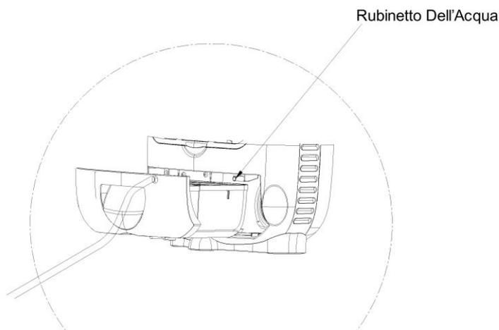
Quando non si vuole più utilizzare il drenaggio dell'acqua permanente, scollegare il tubo di drenaggio dal dispositivo. Assicurarsi che il contenitore dell'acqua sia posizionato correttamente.
