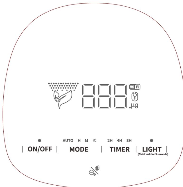
Når luftrenseren plugges i vil LED-indikatorene lyse i ett sekund og deretter slå seg av – luftrenseren er i standby-modus. Displayet er en berøringsskjerm, trykk på knappene raskt og bestemt hvis ikke annet er angitt.
