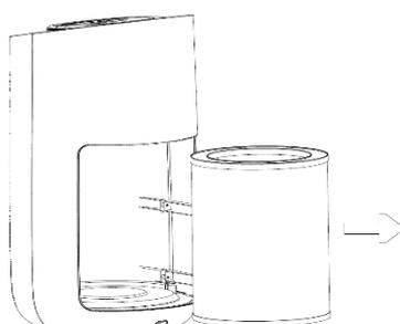
**2. Poussez le filtre vers le bas et tournez-le dans le sens des aiguilles d'une montre pour le retirer.**
