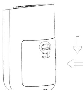
**5. Remplacez le couvercle du filtre en place. Appuyez sur le bouton du couvercle pour le réinsérer.**
