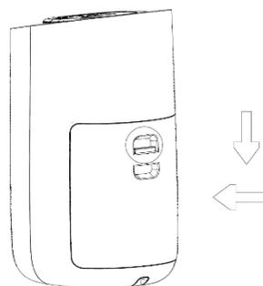
**5. Remplacez le couvercle du filtre. Appuyez sur le bouton du couvercle pour le réinsérer.**
