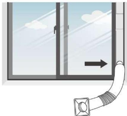
**Schritt 5: Befestigen Sie das Abluftrohr über den Luftauslass des mobilen Klimageräts mit dem Anschlussstück.**
