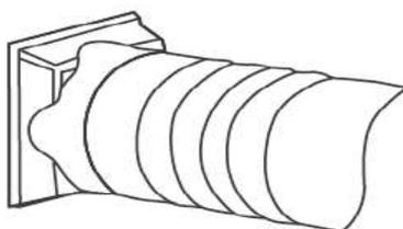
**Schritt 2: Verbinden Sie das andere Ende des Kanals mit dem Anschlussstück mit einer Drehbewegung auf der Fensterseite. Bitte wenden Sie beim Anschließen keine Kraft an.**
