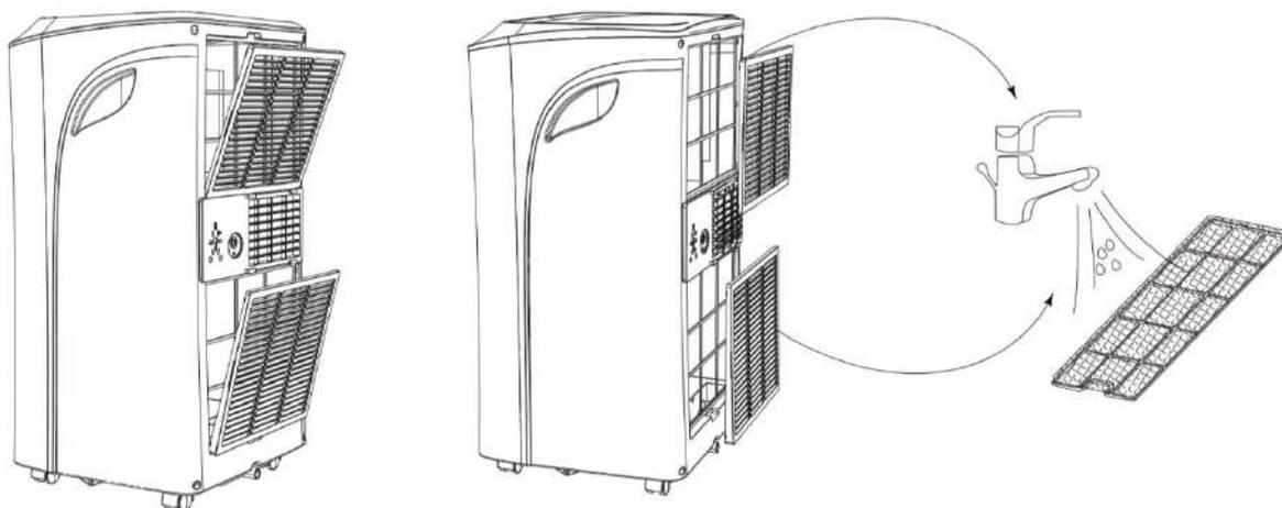
Lassen Sie vor dem Bewegen oder Lagern des mobilen Klimageräts das gesammelte Wasser mit dem mitgelieferten Abflussschlauch ab (weitere Informationen auf Seite 14). Verwenden Sie bei der Lagerung des Klimageräts das Kabelfach zur Aufbewahrung des Netzkabels. Reinigen Sie die Filter und bewahren Sie das Gerät in der Plastiktüte oder Originalverpackung auf, um es vor Staub zu schützen.
