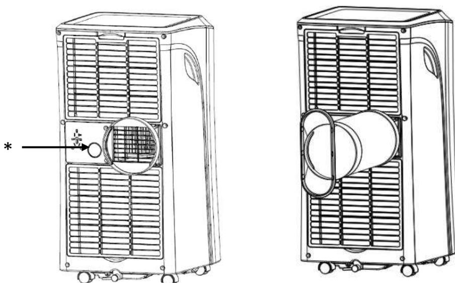
*\* Während der Kühlung dürfen Sie diesen Stopfen nicht entfernen. Dies ist der Wasserrevisor, in dem das Wasser sitzt, bis es über den Kanal verdunstet ist.*
