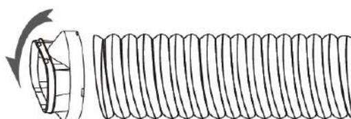
**Schritt 3: Befestigen Sie das Abluftrohr mit dem Anschlussstück an dem Fenster-Kit.**
