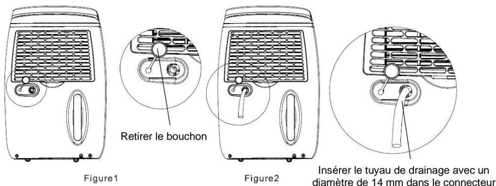
Pour utiliser un drainage en continu, retirez le bouchon à l'arrière de l'appareil et poussez le tuyau de 14 mm à travers le trou en le fixant à l'orifice de sortie interne (pour que le drainage en continu fonctionne, le réservoir d'eau doit toujours être en place).
