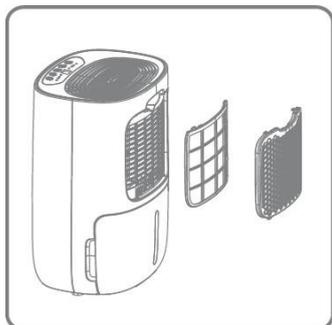
Le filtre peut être nettoyé à l'aide d'un aspirateur ou dans de l'eau chaude savonneuse en dessous de 40°C. Assurez-vous que le filtre est parfaitement sec avant de le réinsérer dans le déshumidificateur.
