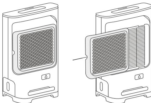
Il filtro antipolvere è un filtro a vita e quindi non dovrebbe essere sostituito (se non per motivi di usura). Se usato regolarmente, il filtro può intasarsi con polvere e particelle di sporco. Il filtro deve essere pulito almeno ogni due settimane (in caso contrario, la garanzia dell'unità potrebbe essere invalidata). Segui i passaggi riportati di seguito.
