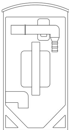
All'interno del serbatoio dell'acqua c'è un galleggiante. È importante **NON** togliere il galleggiante dal serbatoio dell'acqua. Il galleggiante misura il livello dell'acqua nel serbatoio e fa scattare il sensore per spegnere il deumidificatore quando il serbatoio è pieno. Se il galleggiante viene rimosso dal serbatoio dell'acqua, il deumidificatore non funzionerà.
