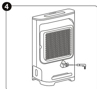
4 Apri la guarnizione nera sul retro del deumidificatore e inserisci l'adattatore per tubo flessibile.
