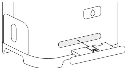
Inserisci il cavo nella parte posteriore inferiore del deumidificatore. Assicurati che sia inserito nel verso corretto, mantenendo il taglio nella parte superiore.
