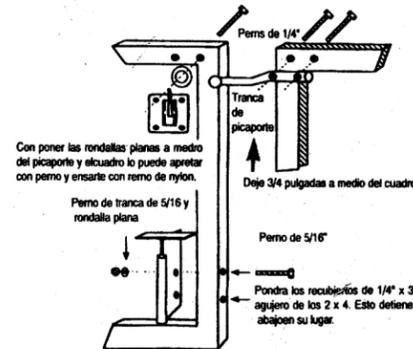
Determine lo hancho que quiera y mida la distancia de adentro del cuadro. Corte dos 2x4 de largo y instale los usando los tornillos de recubrir de 3 pulgadas. Si uste extiende su puerta 5 pies -0- mas, agujere agujeros de 1/4" atraves del cuadro, despues que instale las tronillosde recubrir de 3" adicionales que estan poporcionados y ensenados.
