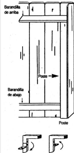
Si la puerta se movera para fuera, instala la cara de la tabla primero a los dos lados, si va a moverse para dentro no necessita poner las tablas de cara.
